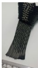
12K CF BRAIDING 幅 1.2インチ(30mm)
