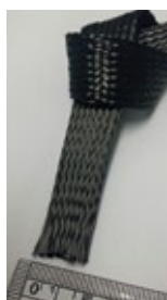
3K CF BRAIDING 幅 0.6インチ(15mm)
