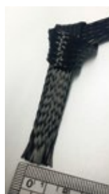
3K CF BRAIDING 幅 0.4インチ(10mm)
